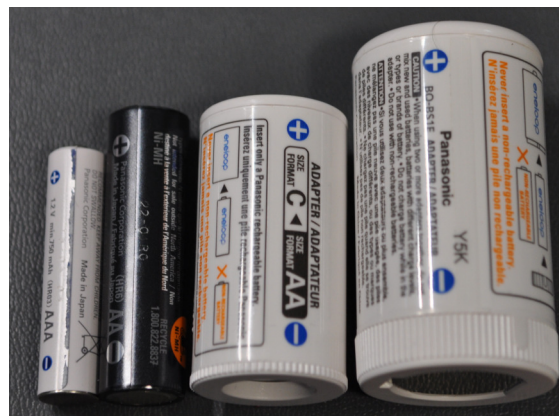
Figure 6.4 – Piles Ni-MH (AAA et AA) avec adaptateurs (C et D).
