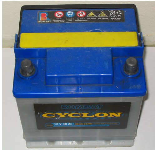
Figure 6.3 – Batterie automobile au plomb de 12 V.
