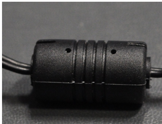
Figure 12.4 – Ferrite autour d'un fil.
