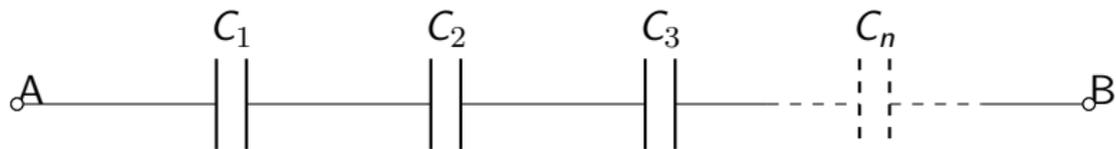
$$C_{eq} = \frac{1}{1/c_1 + 1/c_2 + 1/c_3 \dots 1/c_n} \quad (11.2)$$
