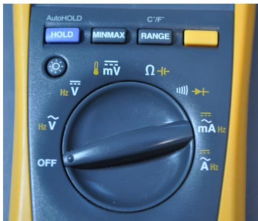
Figure 22.2 – Sélecteur de fonctions d'un multimètre.
